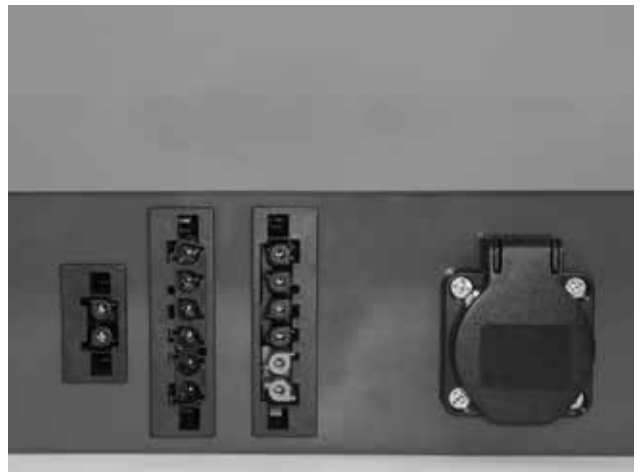
Abb. 12 - Brenner / zwei 6 Pin-Konnektore, - links Spannung, rechts Fühler, 2 Pin-Konnektore für Zusatzkabel (R3 und R4) und Steckdose für Förderschnecke
