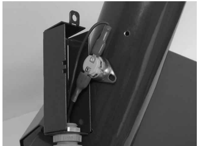
Abb. 10 - Sicherheitsthermostat am Rohr für Pelletzufuhr 95 °C
