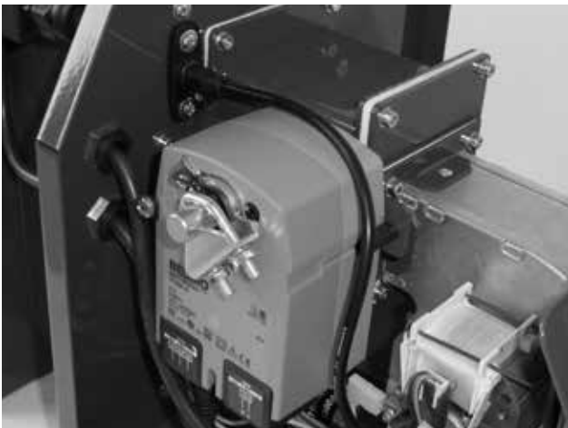
Abb. 11 - Sonderklappe mit Stellantrieb
