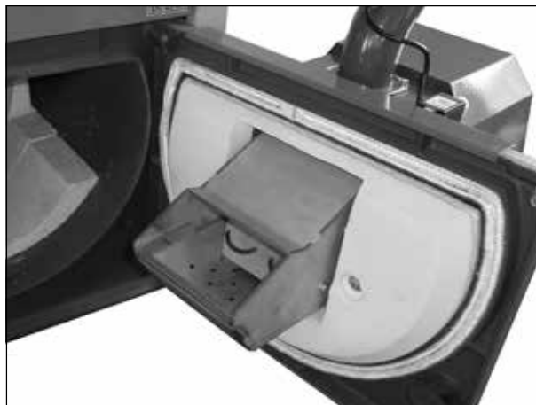
Offene untere Kesselkammer bei der Reinigung von Brennerschale - ATMOS A25 / A45 (DC40GSP)
