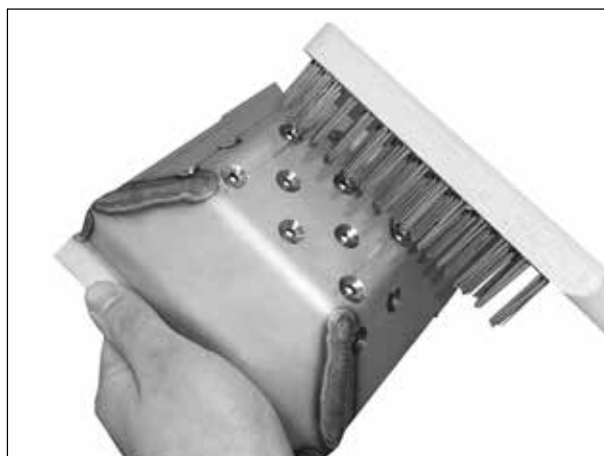
Beispiel: Reinigung der Brennkammer
