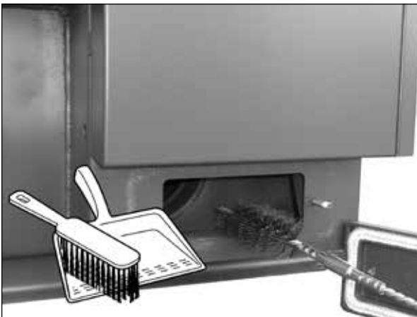
Vorführung der Reinigung des Rauchkanals mit Drahtbürste.
