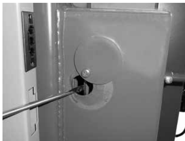
Die Kontrolle und Reinigung der Öffnung bei der Primär-sekundärluft (Einstellhebel)
