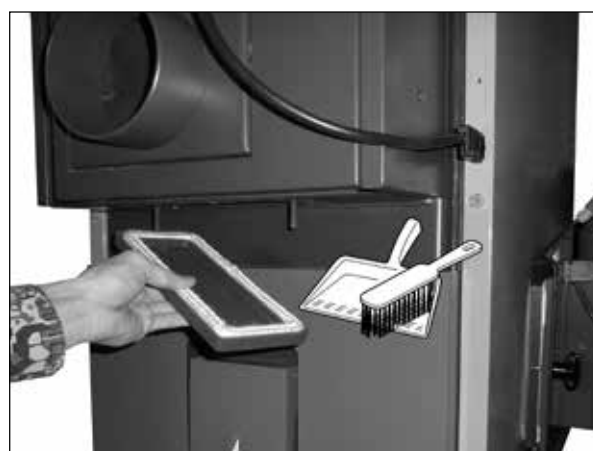
Veranschaulichung der Reinigung des Rauchabzuges im hinteren Bereich des Kessels.
