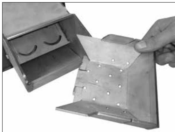
Herausnehmbare Verbrennungskammer mit den Öffnungen für die Luftzufuhr – muss regelmäßig gereinigt werden
