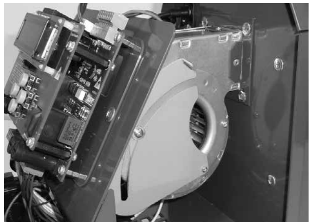
Brennerventilator mit der Luftklappe. Durch Öffnen der Luftklappe wird die Flammenlänge verkürzt.
