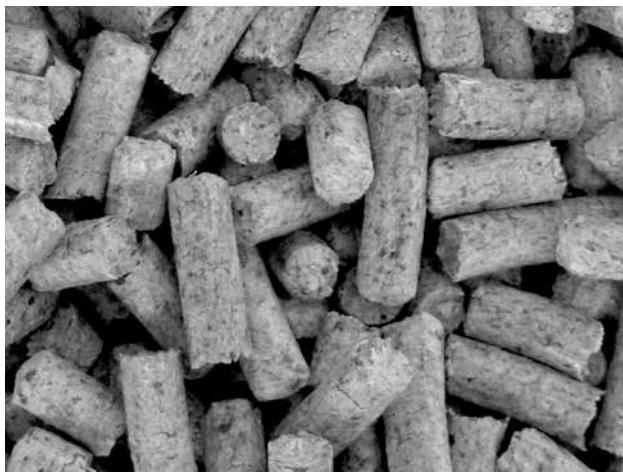
Mangelhafte Holzpellets – dunkle mit Rinde (mit schwarzen Punkten)
